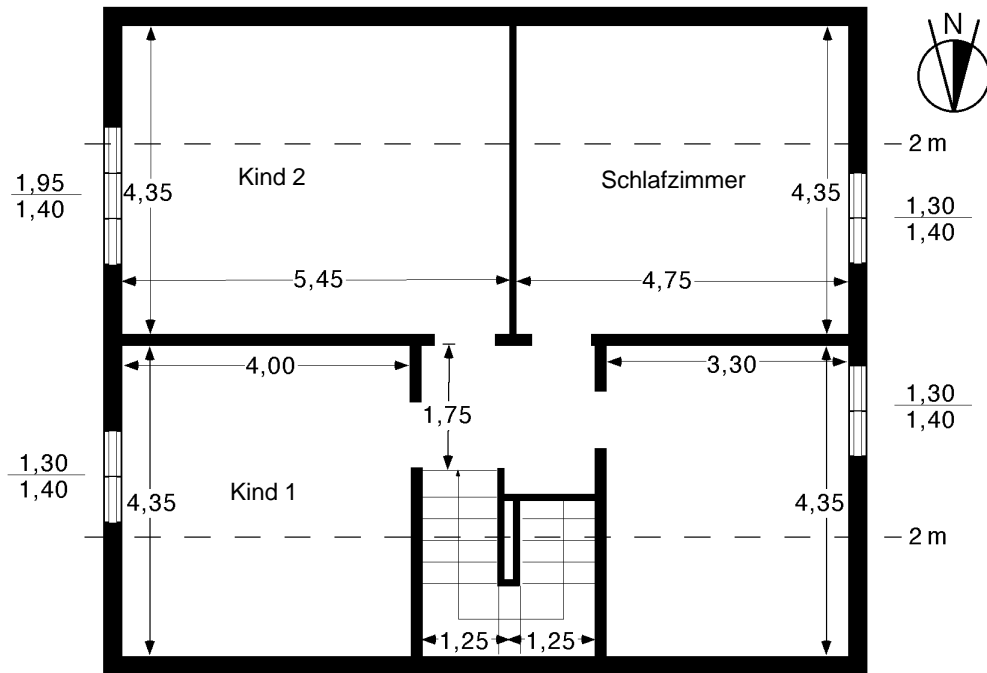
Bild 3: Dachgeschoss des Einfamilienhauses
